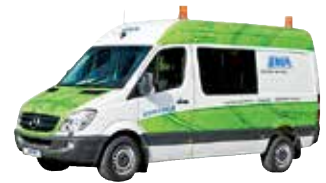
➤ Cable test van transcable
