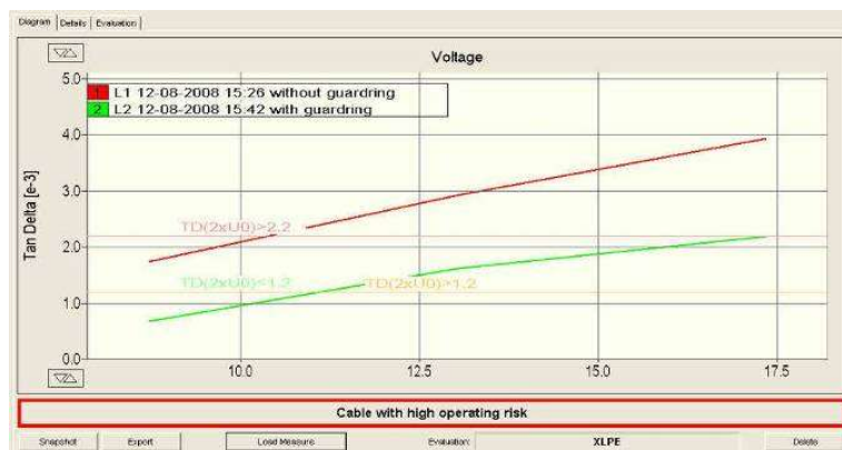
Obr. 62: Přímé srovnání hodnoty TD při použití ochranného kroužku a bez použití ochranného kroužku
