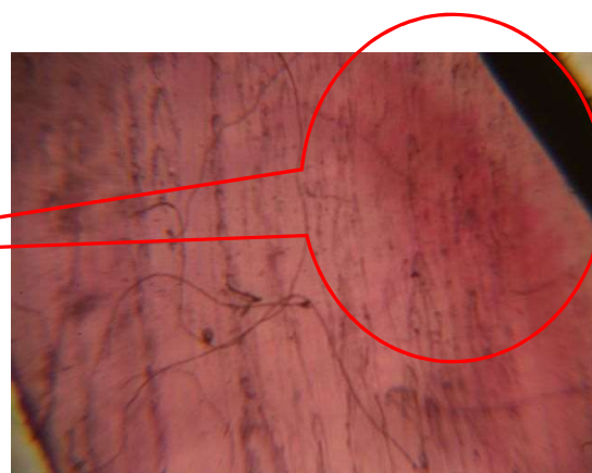
Viditelné bílé skvrny po odstranění polovodivé vrstvy
