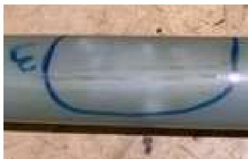
Rozbor úseku č. 3 se skvrnami vodních stromečků
