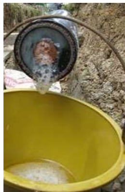
Obr. 40: Nedostatečné odplynění kabelu ve výrobě, po 14 měsících v provozu
