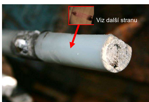
Předpokládaný vodní stromeček vyvinutý v blízkosti vadného místa
