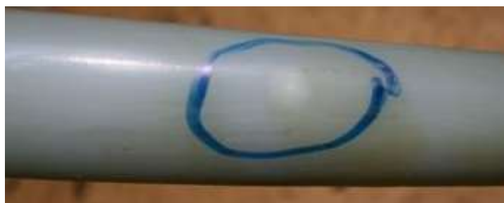
Viditelné bílé skvrny po odstranění polovodivé vrstvy
