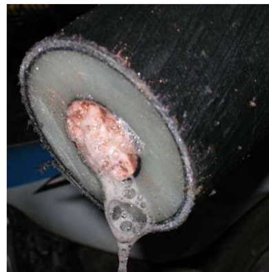
Obr. 40: Nedostatečné odplynění kabelu ve výrobě, po 14 měsících v provozu
