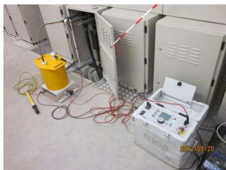
Obr. 89: Přenosný terénní detektor PD s lokalizací PD (přenosný BAUR PD)
