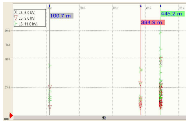
Obr. 90: Graf PD kabelu XLPE s aktivitou PD soustředěnou ve 3 spojích
