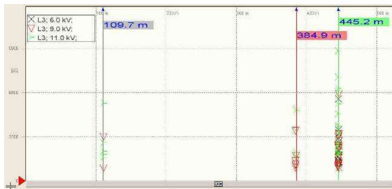
Obr. 74: PD Lokalizační graf kabelu XLPE se 3 spoji s aktivitou PD
