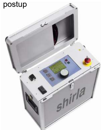
Obr. 5.32; Shirla ( plášť , zkouška izolace a analyzátor odporu a místa poruchy)
