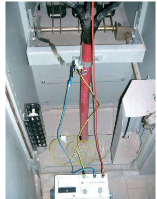
Obr. 6.1: Galvanické připojení generátoru zvukových frekvencí TG 20/50
