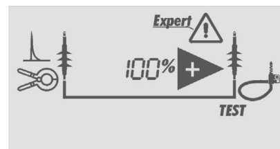
Obr. 8.7: Displej přijímače KSG 100 ukazující směr, hodnotu, vodivost vedení
