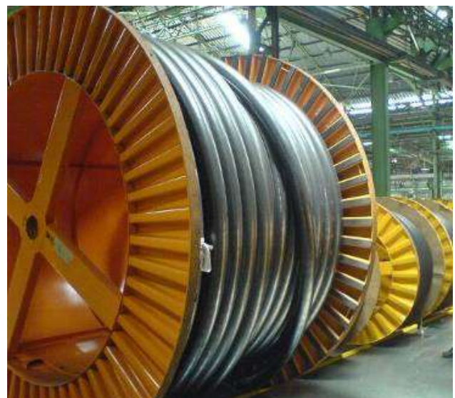
Obr. 2.5; Kabel na bubnu, 115kV, jednožilový
