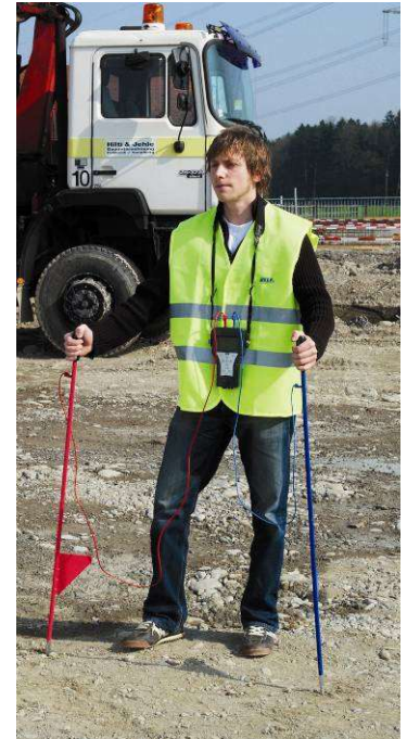
Obr. 7.9: Metoda krokového napětí, dvě zemní sondy připojené k vodičům kabelu.
