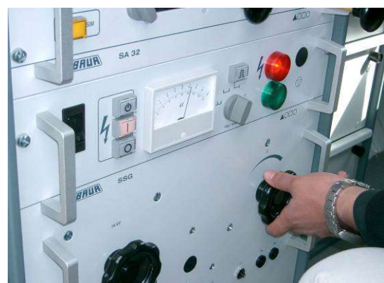
Obr. 5.7; Nastavení napětí a volba rozsahu napětí rázového generátoru SSG
