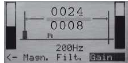
Obr. 7.8: displej UL30, režim kabelových šachet, zobrazení dvou hodnot času průchodu sloužících k výpočtu vzdálenosti
