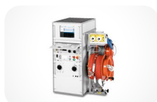
02 / Systém lokalizace poruch kabelů Syscompact 4000 vč. zdroje vysokého napětí
